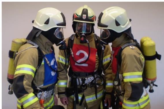
Abb. 11: Dichtprüfung bei Dräger Atemschutzmasken
