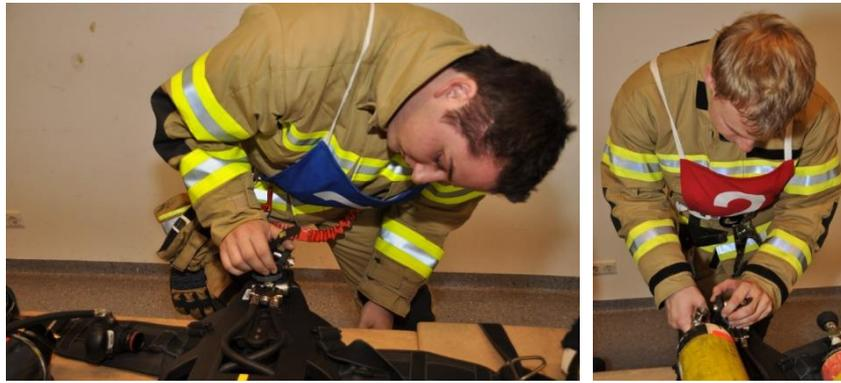
Abb. 20: Öffnen des Spannbandes, Flaschenwechsel, Kontrolle der O-Ringe und Ventile
