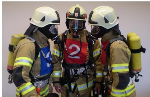
Abb. 11: Dichtprüfung bei Dräger Atemschutzmasken
